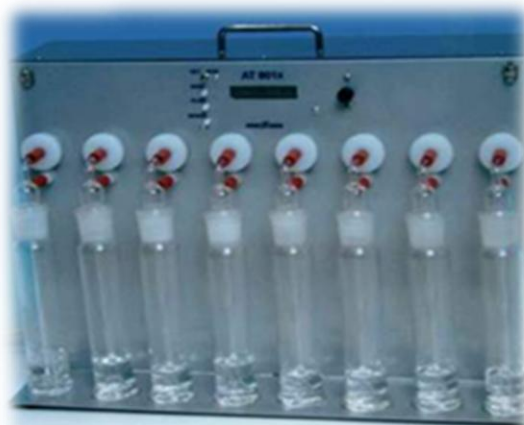
Слика 31. Изглед узоркивача PE-AT.801X
