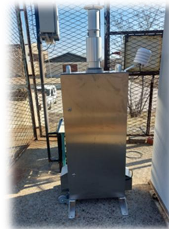
Слика 30. Изглед узоркивача Sven Leckel LVS
