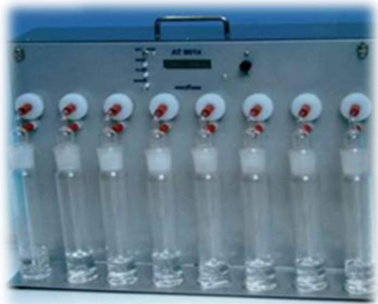
Слика 31. Изглед узоркивача PE-AT.801X
