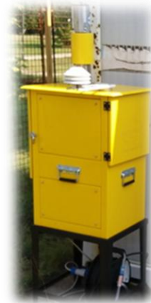
Слика 29. Изглед узоркивача LIFETEK PMS
