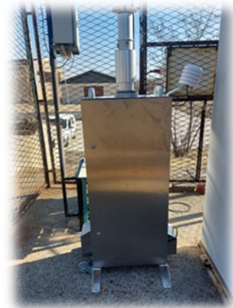
Слика 31. Изглед узоркивача Sven Leckel LVS
