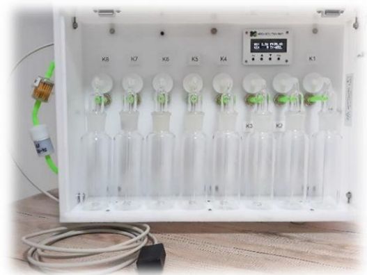
Слика 33. Изглед узоркивача 5G 8R_V1.1_PT
