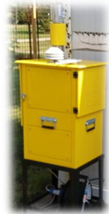
Слика 30. Изглед узоркивача LIFETEK PMS
