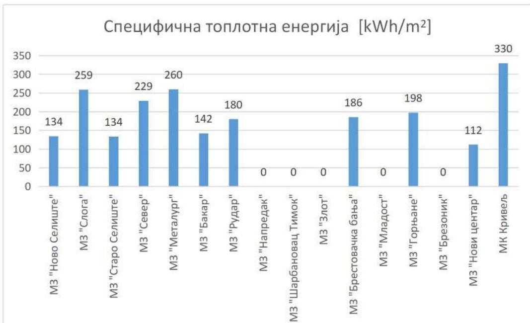
График 61 Специфична потрошња топлотне енергије по површини, у kWh/m<sup>2</sup>
